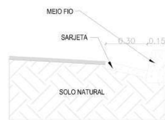
5 DETALHAMENTO SARJETA E MEIO-FIO ESCALA 1 : 10
