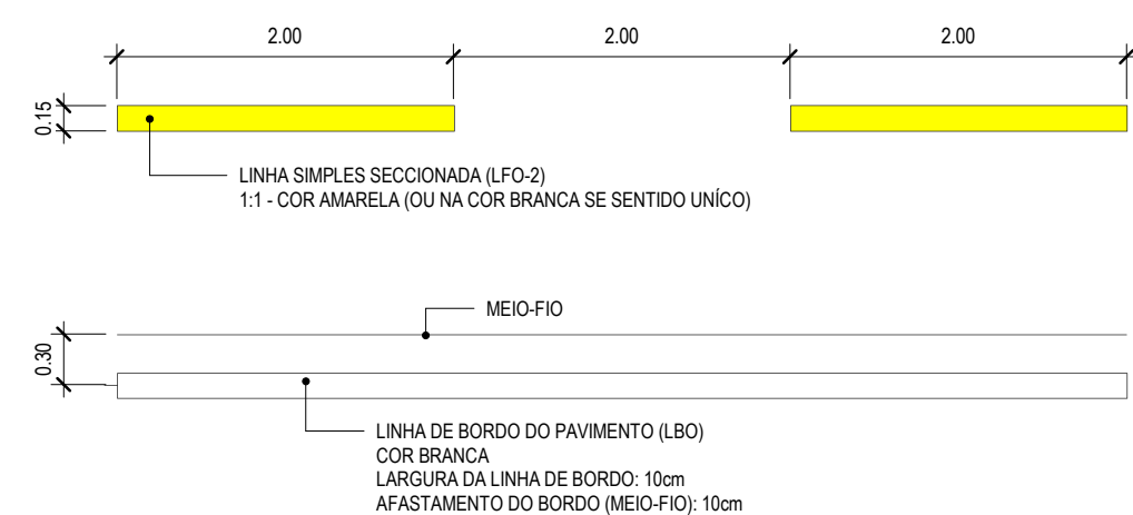
05 DETALHE - PINTURA ESCALA: 1:50
